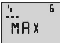
初始化运行的交替显示
