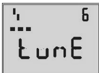
棒形图显示出初始化的过程
