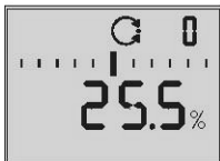
初始化成功 阀门定位器处在自动操作模式下
