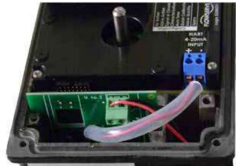
图 33: 安装在定位器内的 V-I 卡
